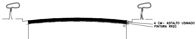
DETALHE DA PAVIMENTAÇÃO S/ESCALA
