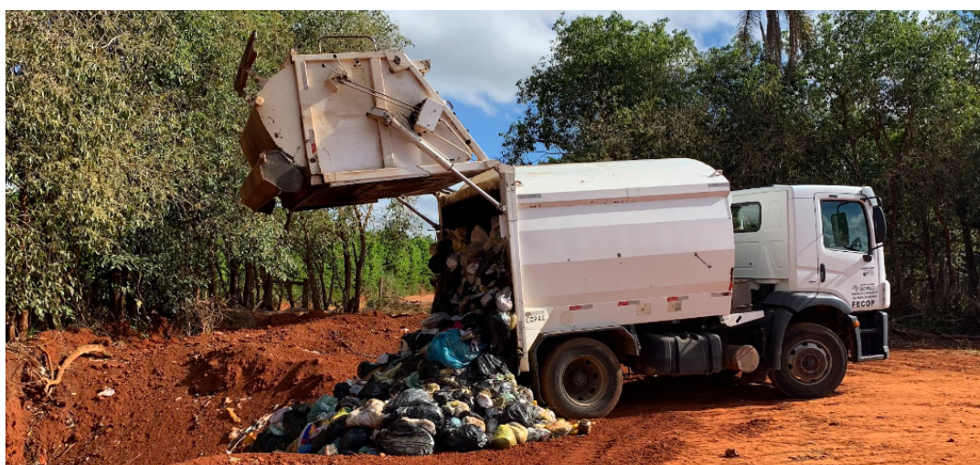
Figura 6 - Resíduos sendo despejados na vala
