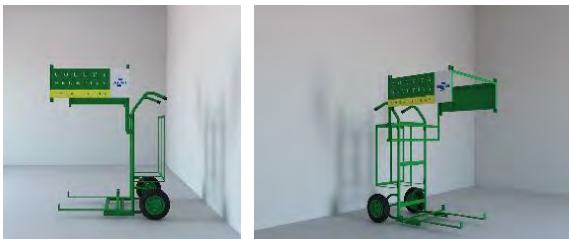
Figura 11 - Dispositivos para a coleta seletiva mista (porta a porta com veículos leves e ponto a ponto com caminhão).
