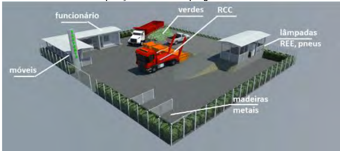
Figura 2 – Layout esquemático do Ecoporto Padrão – área entre 800 e 1.000 m 2 com operação de caminhão poliguindaste.
