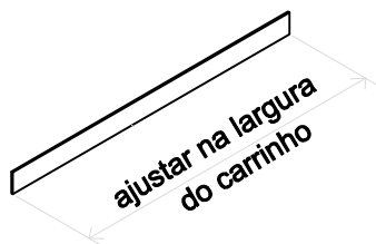
PEÇA "C" (2 unid) Travas em barra de ferro chato 20 mm - e= 0,5mm
